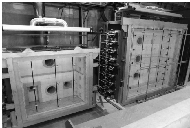
Abb. 1: Moderne Brandschutzprüföfen der Prüf-, Überwachungs- und Zertifizierungsstelle der Stadt Wien in Wien 11 (Quelle: MA 39)
