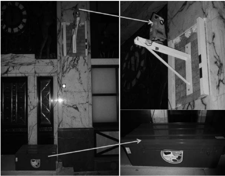
Abb. 7: Präzisionstachymeter auf Messkonsole und Metallbox mit den Steuerungs- und Auswertekomponenten
